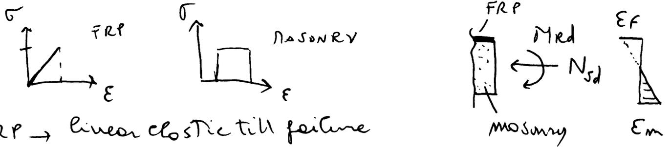
FRP → linear elastic till failure
