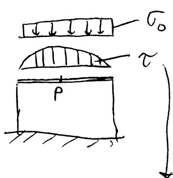
$\sigma_0 \Rightarrow$  in realtà ci sarebbe meno flessione anche con  $N$  centrato (c'è il momento  $V \cdot \frac{b}{2}$ ), ma nel punto centrale, almeno se l'eccentricità è minore di  $l/6$  (sezione non perfettamente), la tensione è propria  $\sigma_0$
