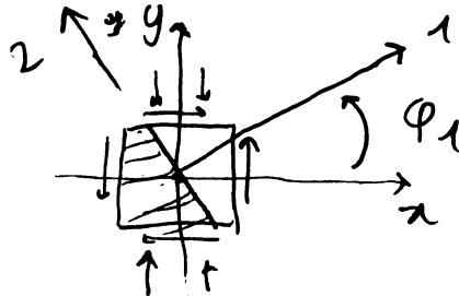
Quello che interessa è il valore di  $\sigma_1$ , tensione principale di trazione: tenendo fissa  $\sigma_2$ , che è un dato di progetto, si faccia aumentare il valore delle forze orizzontali  $V$  (quindi di  $\bar{\tau} = \frac{V}{bt}$ ) e, di conseguenza, il valore di  $\tau_p = b \cdot \bar{\tau}$  che è il minimo sforzo tangenziale che si ha, comunque, al centro del pomello)
